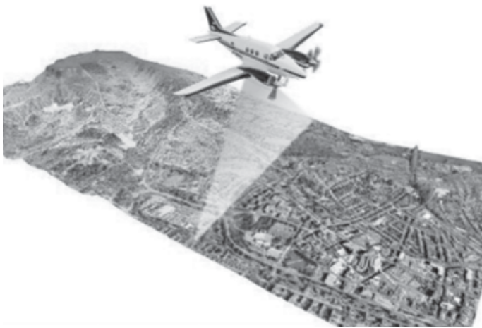
Figure 2 Contoh Pengaplikasian Sistem LiDAR Airborne
