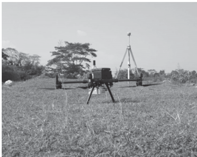
Figure 4. Drone menggunakan LiDAR untuk Mapping lahan pertanian
