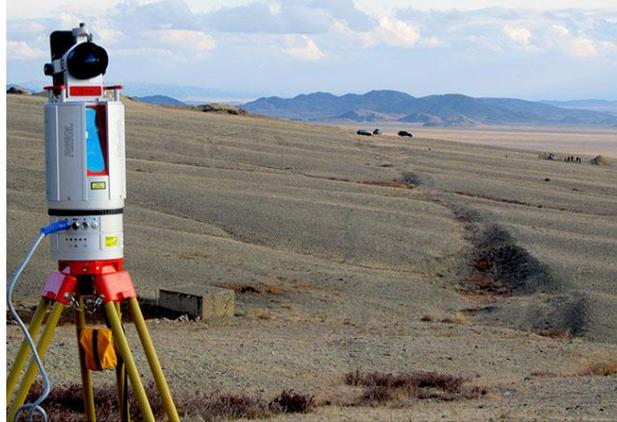
Figure 3 Contoh Pengaplikasian LiDAR Static<sup>3</sup>
